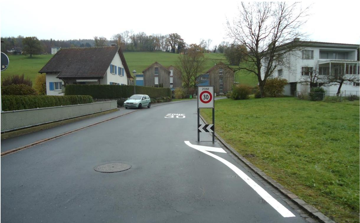
Abb. 7: Beispiele für die Gestaltung einer Torsituation am Beginn einer Tempo-30-Zone
